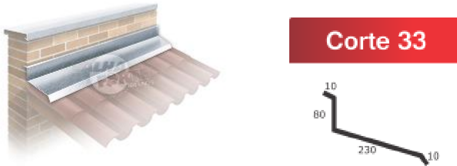
Figura 4 e 5: Ex. da disposição do rufo e seu corte e chapim na platibanda.
