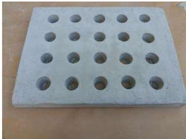
**Figura 7:** Grelha pré-moldada de concreto
