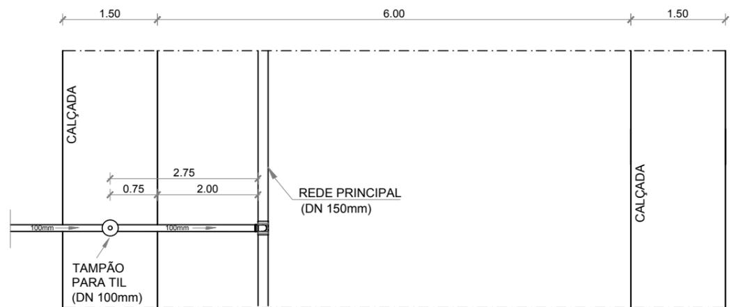
PLANTA BAIXA - POSICIONAMENTO INSTALAÇÕES
